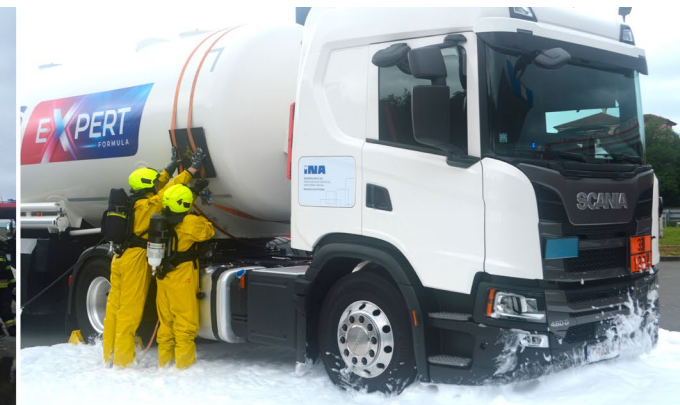
Sanacija oštećenja na cisterni
