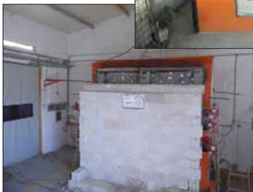
Slika 8, Slika 9: Ispitivanje krovova i parapeta (fasada)
