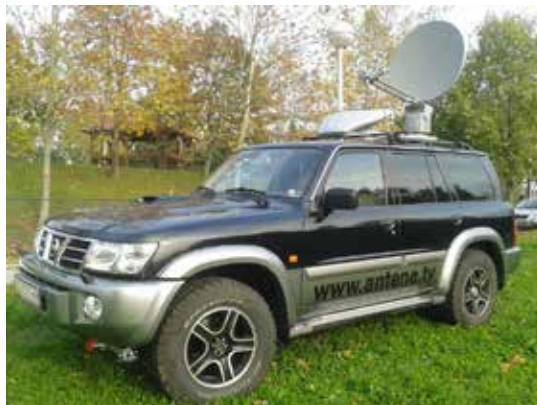
Slika 4. Prenosiva i mobilna primo-predajna zemaljska oprema
