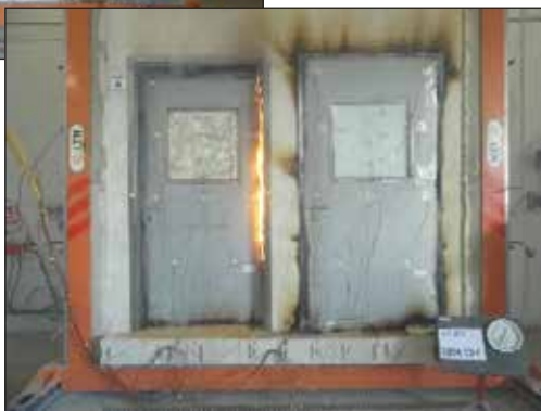
Slika 4, Slika 5: Ispitivanje otpornosti vrata na požar
